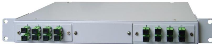
Кросс оптический предназначен для коммутации и распределения оптических волокон кабеля на объектах волоконно-оптических систем связи и эксплуатации в закрытых помещениях при температуре от -5 до +50 °С.
