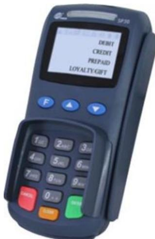
Предназначен для подключения к ПЭВМ оператора почтовой связи работы в составе ПАК РУП «Белпочта» для считывания карт с магнитной полосой, чипом и бесконтактных карт.
